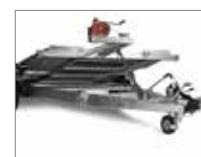
Udstyret med spil, wire og tipcylinder.
